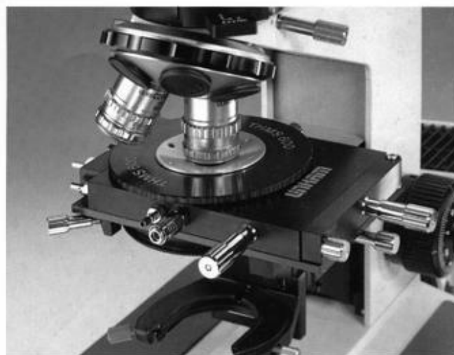
Рисунок 1. Термокриометрическая камера THMS 600, смонтированная на столике микроскопа
